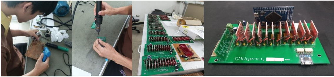
รูปที่ 4.1 จัดทำแผงวงจรเครื่องวัดคลื่นไฟฟ้าหัวใจ
